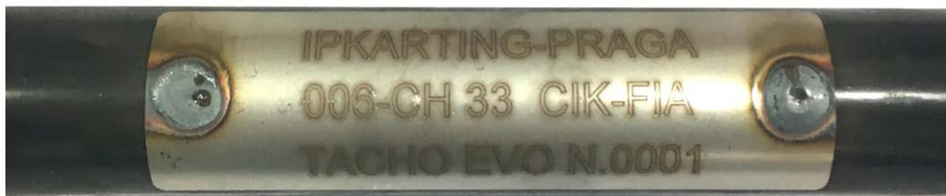
**Le marquage indiqué sur le tube transversal arrière doit rester clairement visible en permanence**
