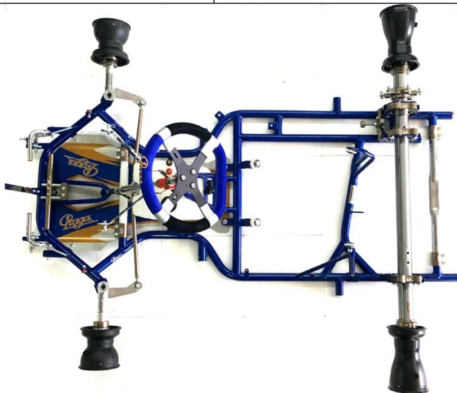
PHOTO VUE DE DESSUS DU CHÂSSIS COMPLET IDENTIQUE À L'UN DES MODÈLES PRÉSENTÉS À L'HOMOLOGATION SANS PARE-CHOCS, FREINS, CARROSSERIE, SIEGE, NI PNEUMATIQUES
